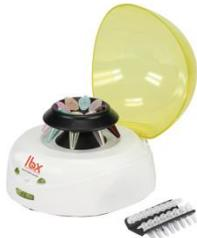
Ideal para centrifugaciones rápidas y técnicas de micro filtración. Tapa disponible en 2 colores: verde y azul. Velocidad fija 7000 rpm (2680xg). Con el equipo se incluyen dos rotores: para 8 tubos 1,5 ml/2 ml y para 2 tiras de 8 tubos de 0,2 ml. Nivel de ruido  $\leq 45$ dB.
