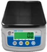
Balanza portátil y de uso sencillo, con función cuenta piezas y de pesaje. Cuerpo robusto en ABS y plato de 148 x 148 mm en acero inoxidable 304. Calibración externa. Opera con una batería de 216 h de autonomía, recargable mediante USB de bajo voltaje, mediante cable incluido.
