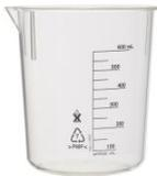
Fabricado en Polimetilpenteno (PMP/TPX®). Mayor transparencia, resistencia química y tolerancia al calor que el PP. Rango de temperatura: -20 °C a +121 °C. Autoclavable. Graduación serigrafiada y fácil de leer. Apilable. Conforme a ISO 7056:1981.
