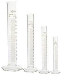
**Tamaños:** 10, 25, 50, 100, 250, 500 y 1000 ml. Fabricadas en vidrio borosilicato LBG 3.3 y diseñadas según norma ISO 4788. Calibradas «para contener» (TC, In).
