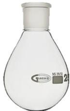
Fabricado en vidrio borosilicato 3.3 de calidad superior. Para uso en evaporador rotativo.
