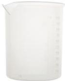
Con graduación en relieve. Autoclavable hasta 121 °C. Conforme a ISO 7056.
